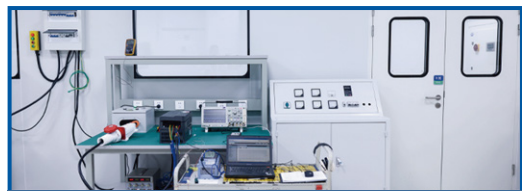
变频器测试平台
